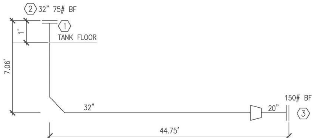
TANK 17 - TEST SEGMENT A SCALE: N.T.S.
